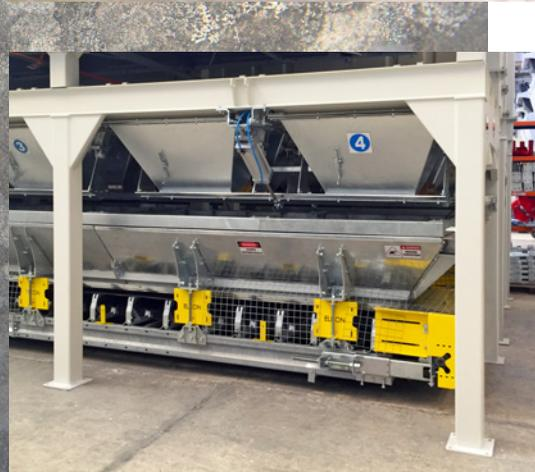
Конусы выгрузки и дозаторный лоток бункеров для инертных материалов
