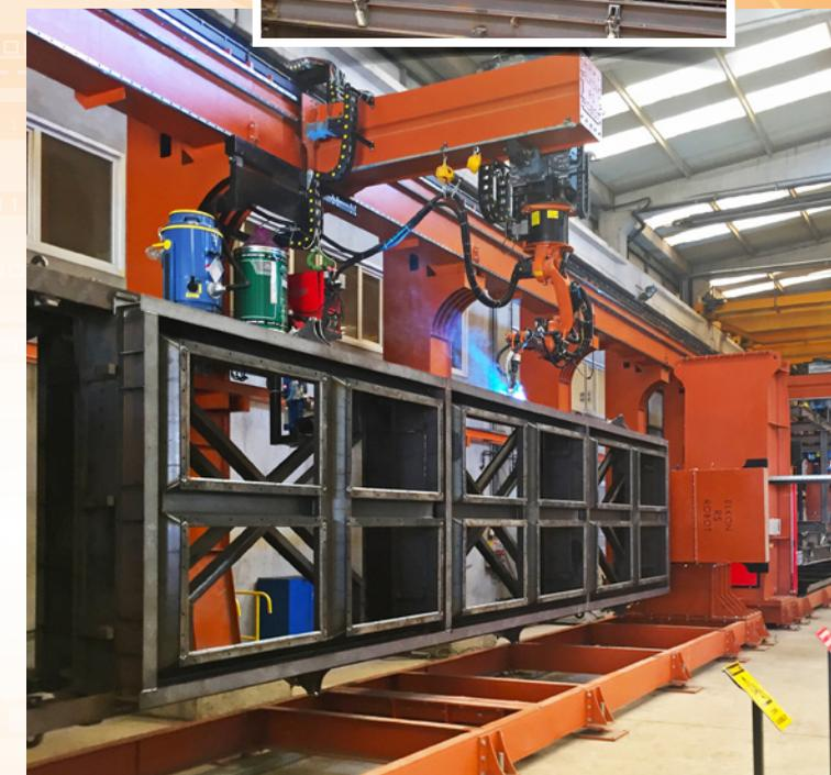
Роботизированная линия по производству бункеров для инертных материалов
